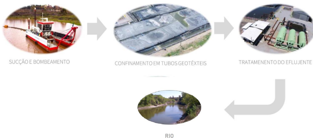
Figura 3.4 – Esquema confinamento dos rejeitos/sedimentos em tubos Geotêxteis (fonte: Arquivo Vale, 2019 - modificado)
